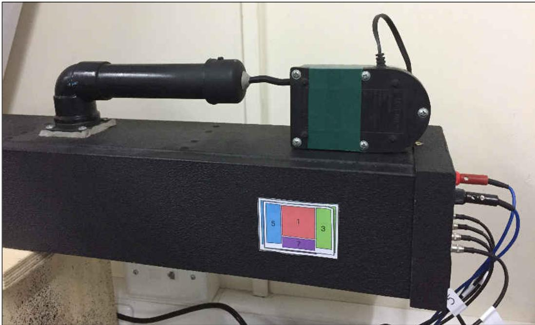
Figura 5.13: Configuración de la bomba de aire conectada a una de las boquillas del prototipo
