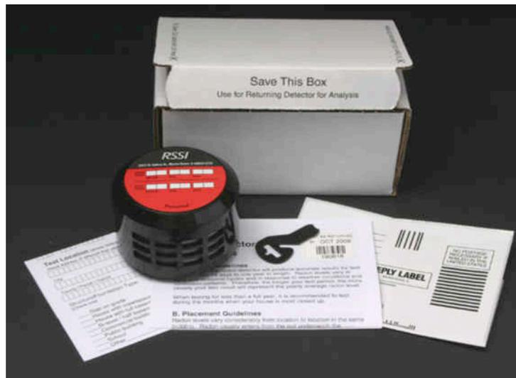
Figura 2.5: Imagen del Detector Alpha Track
